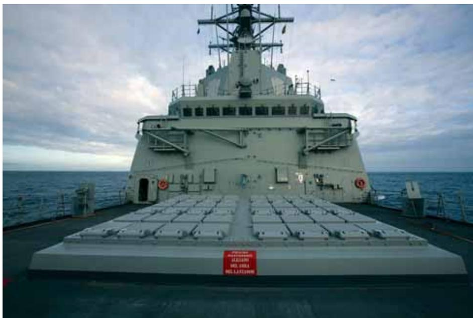
Silos de misiles en una gran unidad oceánica. La posibilidad de integrar sistemas de combate de detección y localización muy potentes con armamento de rápido disparo simultáneo y largo alcance permite establecer cortinas de protección eficaces y prácticamente impenetrables ante las clásicas amenazas aéreas y submarinas.
